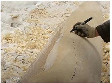
Затем заготовка переворачивалась вверх дном и при помощи рубанка осуществлялась чистовая обработка днища. После этого при помощи карандаша, на глаз прорисовывались контуры будущих бортов. Для того, чтобы при последующей чистовой выемки древесины, стенки бортов оставались одинаковой толщины, необходимо было установить так называемые сторожки. Сторожки нарезались из веток крушины, толщиной примерно 5 мм и имели длину 20 мм. Крушина использовалась
