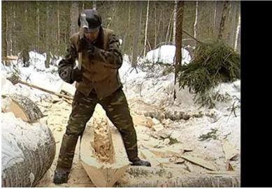
Таким образом задавались наружные очертания судна, после чего приступали к самой сложной операции – внутренней обработке. При помощи тесла из ствола выбиралась сердцевина и заготовка судна приобретала вид грубой колоды.
